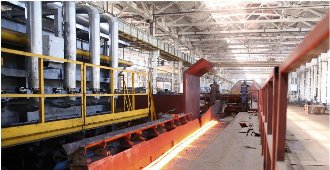
Оборудованием прокатного производства ТМПЗ является полуунпрерывный мелкосортный стан 300, который позволяет выпускать широкий ассортимет продукции.
